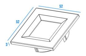
\*Inicie instalação pela serra copo de 44mm para melhor fixação do produto. Para 46mm caso achar necessário utilize um pouco de cola nas aletas. Isso dependerá do fabricante de serra copo.
